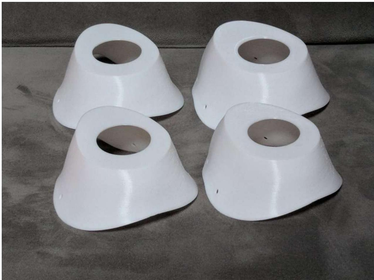
**Figura 8.** Quattro mascherine con dimensioni differenti (S-M, M, M-L, L). Le dimensioni possono essere ulteriormente variate tramite un qualsiasi programma di modellazione 3D e in più ogni mascherina può essere adattata soggettivamente scaldandola con phon o acqua calda a circa 60 gradi.
