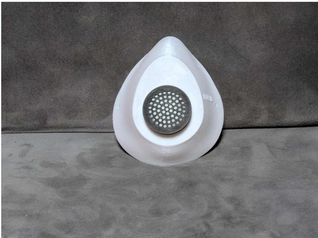
**Fig. 17.** Assemblare la mascherina con la cartuccia del filtro (introdurre la vite all'interno della mascherina ed avvitare il tappo con i filtri sulla parte che fuoriesce dal foro).
